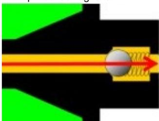
Eintretendes Injektionsmaterial schiebt die Rückschlagkugel zum Packerende. Nach der Injektion drückt der Materialdruck die Rückschlagkugel zurück gegen den Injektionskanal und verhindert somit einen ungewollten Materialaustritt.
